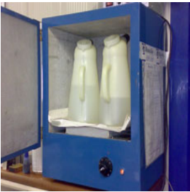
Forno riscalda resina
